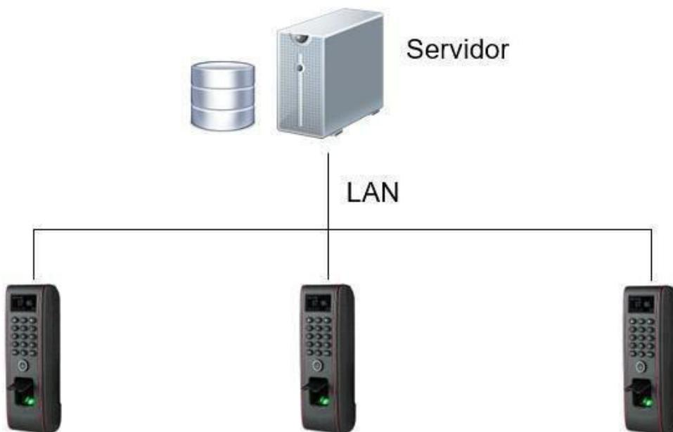
*Figura 3: Diagrama básico do sistema de controle de acesso*
