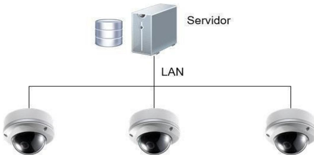
*Figura 2: Diagrama básico do sistema de CFTV*
